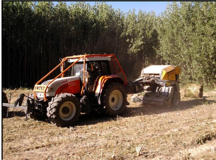
Apeo y astillado integrados: con cosechadora-astilladora, seguido del transporte de las astillas a planta.
