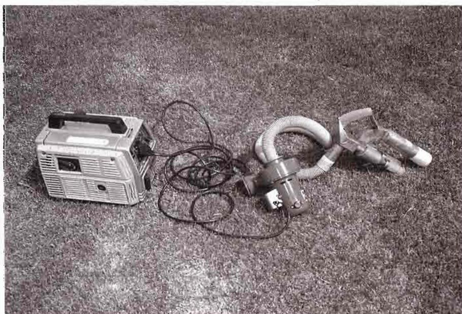
Figura 9. Componentes de un recolector de tipo ciclón.
