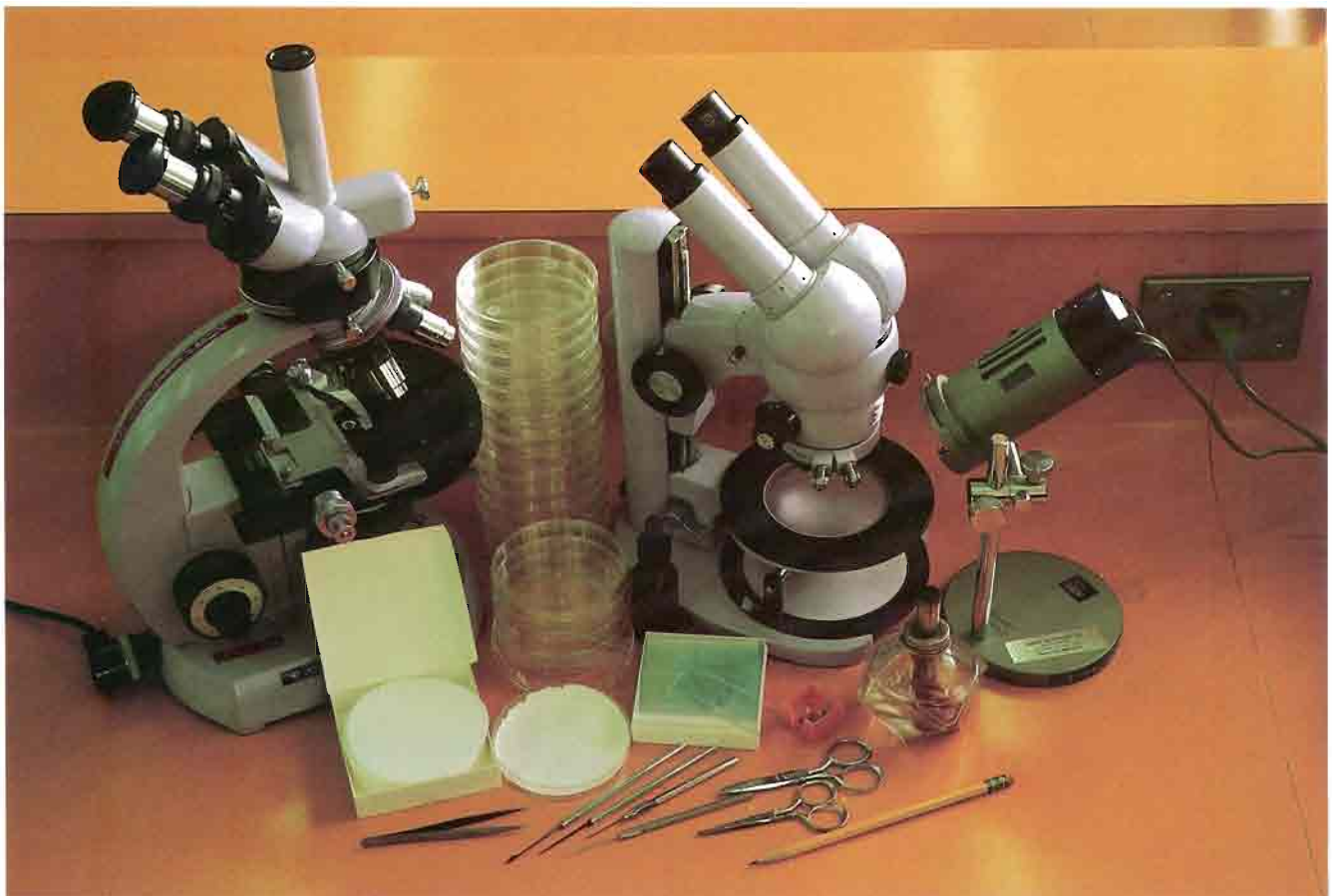
Figura 5. Equipo necesario para hacer observaciones de laboratorio que incluyen dos clases de microscopios (dissección y compuesto), cajas Petri, papel filtro, pinzas, agujas de disección y escalpelo, un gotero con agua y portaobjetos con cubreobjetos.
