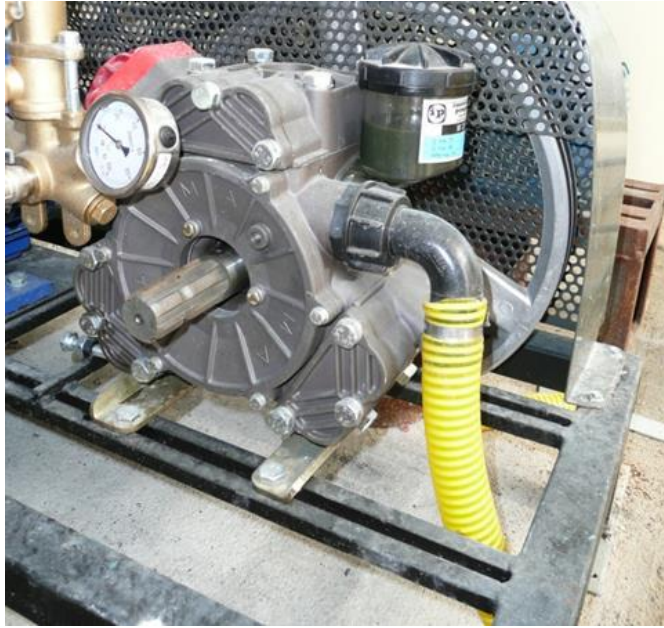
Equipo sin señales de humedad, sin fugas ni goteo por ninguna junta de la bomba
