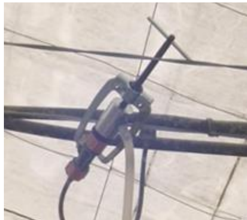
Detalle de la conexión del adaptador del banco de probetas a la boquilla
