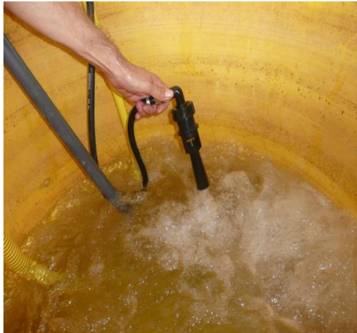
Sistema de agitación hidráulica con recirculación claramente visible
