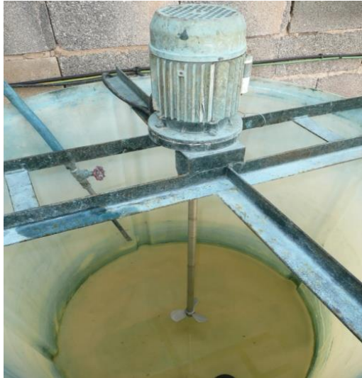
Sistema de agitación mecánica por transmisión directa de un eje del motor a la hélice
