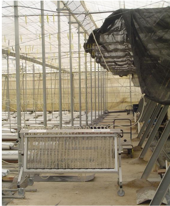
Medida del caudal con un banco de ensayo de probetas
