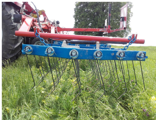
Figure 1 - La posición del cilindro hidráulico se regula a través de un controlador mediante válvulas magnéticas. El controlador decide en función de la posición del cilindro en qué dirección se puede variar el ángulo de las púas.
