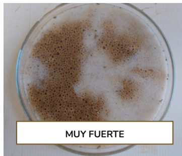
Ejemplos de reacciones del suelo a la aplicación de vinagre de limpieza para detectar la presencia de carbonatos.
