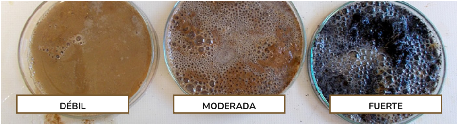
Ejemplos de reacciones del suelo a la aplicación de agua oxigenada para detectar la presencia de materia orgánica.
