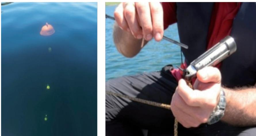
Figura 4. Fotografía de la boya sumergida en el agua con los diferentes termistores colgados de ella a diferentes profundidades (izquierda), termistor HOBO (derecha)
