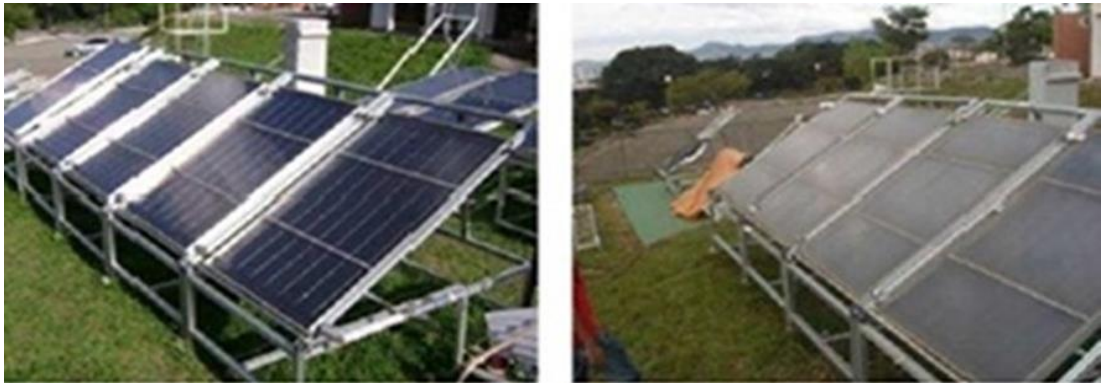
Figura 104: Comparación de ensayos de captadores solares con y sin suciedad en la cubierta
