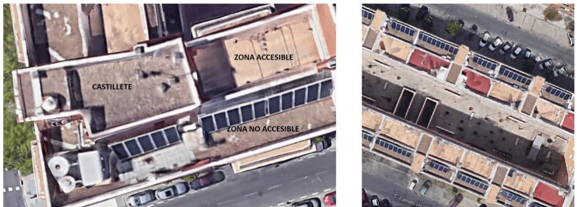
Figura 66: Ejemplos de captadores instalados en zonas técnicas
