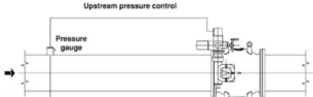
**CONTROL LOCAL:** Si la válvula cuenta con un actuador con centro de control incorporado, y los valores de control son locales, el conjunto de actuador puede asumir el posicionamiento de acuerdo con las condiciones de trabajo estipuladas.
