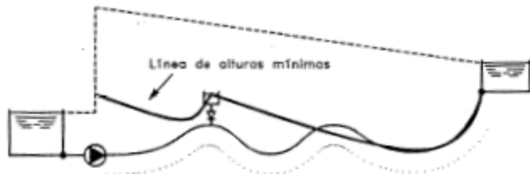
(a) Conducción con un tanque unidireccional
