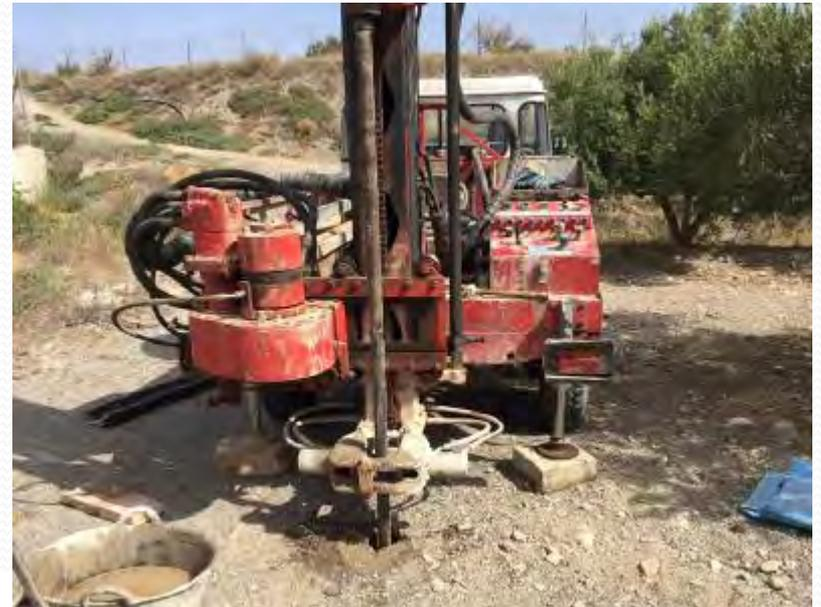
Así mismo, el **sondeo** geotécnico tiene como misión la toma de muestras de calidad adecuada para su análisis en laboratorio, y la ejecución de ensayos “in situ” que permitan valorar los parámetros **geotécnicos** del terreno, en especial en aquellos casos en los que la toma de muestras no alteradas
