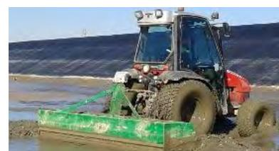
**Figura 2.** Detalle tractor equipado con ruedas especiales para acarrear los sedimentos a una esquina de la balsa
