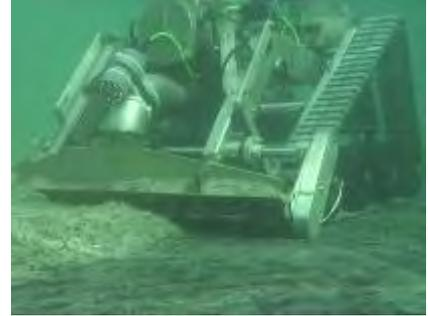
**Figura 6.** Robot Weda YT-840 que forma parte del equipamiento para pequeñas actuaciones de Limpiabalsas®
