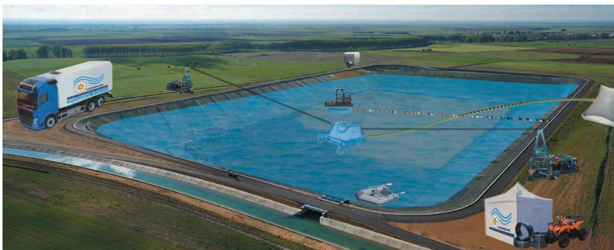
**Figura 12.** Arriba esquema Método Limpiabalsas<sup>®</sup>, con robot submarino, traccionado desde pista perimetral; sobre él, armario de distribución de potencia, control y protecciones. En esquina derecha carpa de control, y al fondo a la derecha, sacas recogida de áridos gruesos. **A la derecha**, foto con sacas filtrantes
