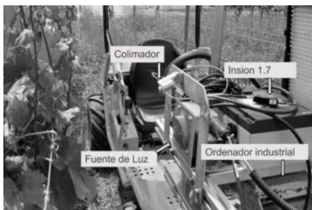
Fig. 1. Sistema de adquisición espectral NIR instalado en una plataforma móvil terrestre para evaluar el estado hídrico del viñedo.
