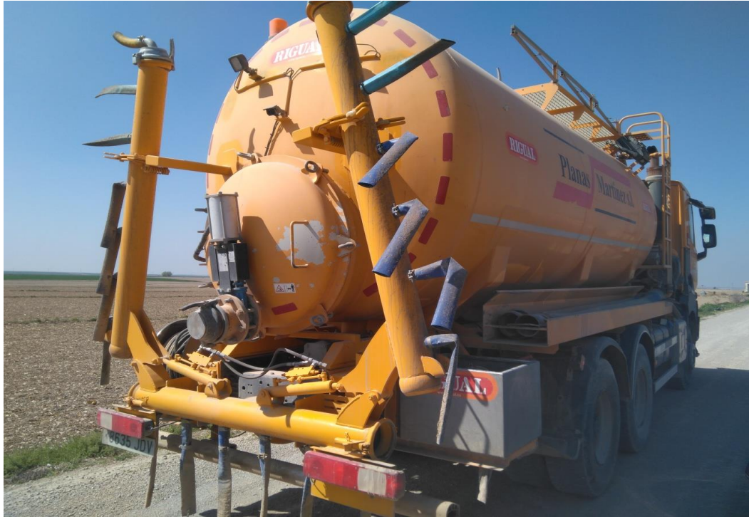
Figura 11: Camión cisterna con aplicador de tubos colgantes.
