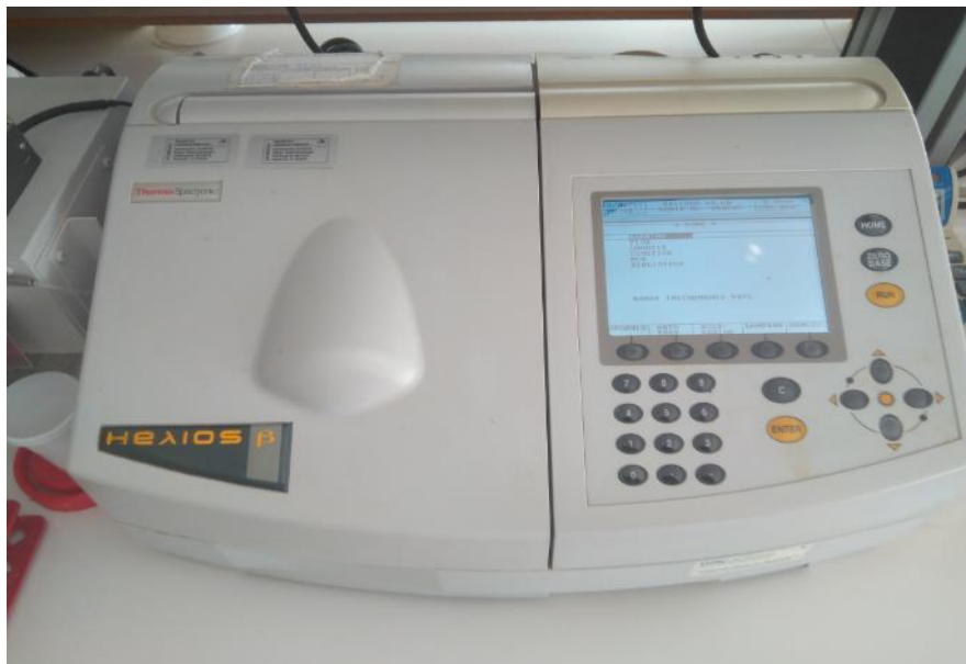
Figura 20: Espectrofotómetro utilizado para la medición de nitratos.
