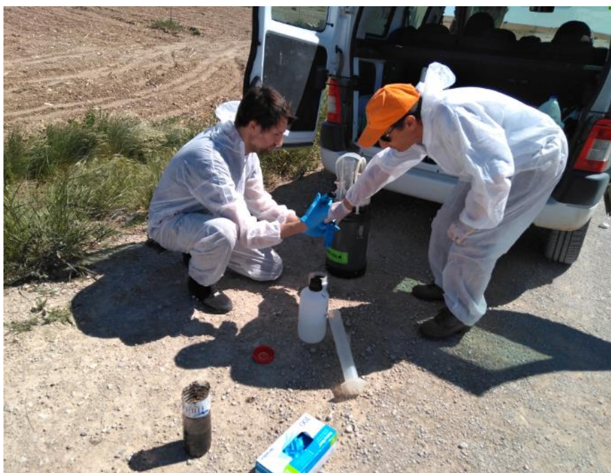
Figura 13: Análisis de purín por el método de Quantofix.
