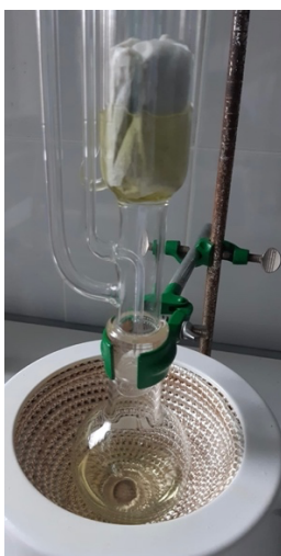
Figura 1. Proceso de extracción Soxhlet de la muestra de Artemisia annua L.
