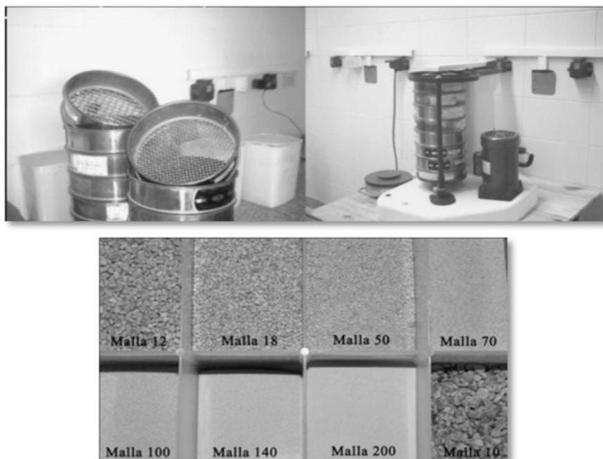
Nota: Equipo de laboratorio usado para la obtención de las distintas granulometrías
