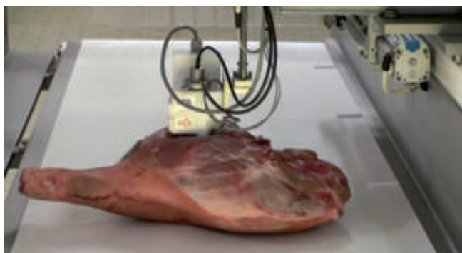
Imagen 54. Equipo para clasificar jamones en base al pH.
