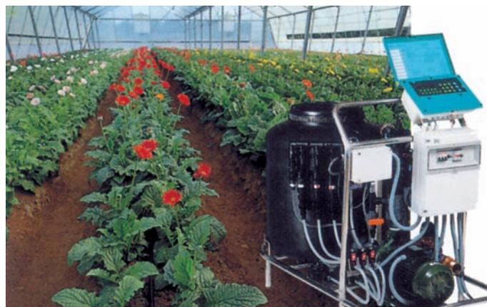
Figura 15. Aparato de fertirriego para riego localizado.
