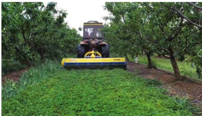
Foto 2. Manejo de la cubierta vegetal. Trituradora de martillo. Fuente: Vimar.
