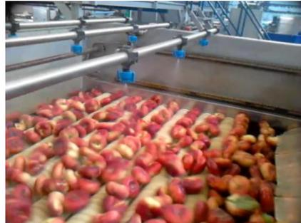
**Figura 6.** Aplicación de fungicida en balsa de inmersión (izquierda) o en boquillas o duchas de pulverización en línea de confección (derecha)
