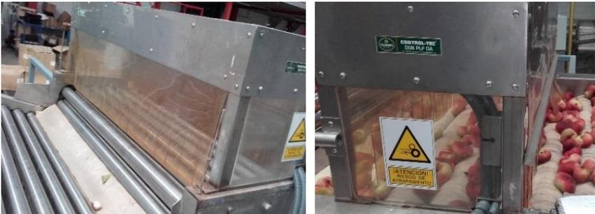
**Figura 7.** Módulo de aplicación sobre rodillos metálicos o sobre rodillos de espuma (donuts)
