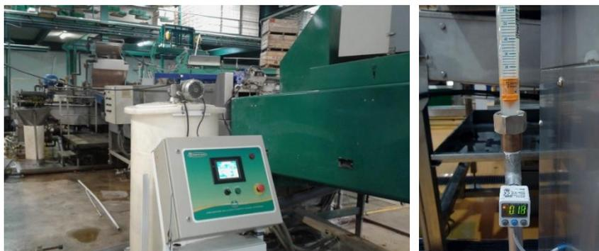
**Figura 10.** Sistema de control de dosis en función de los palots que entran en la línea a la izquierda (Tecnidex®), detalle del caudal que se aplica en la línea a la derecha (Rubies®)
