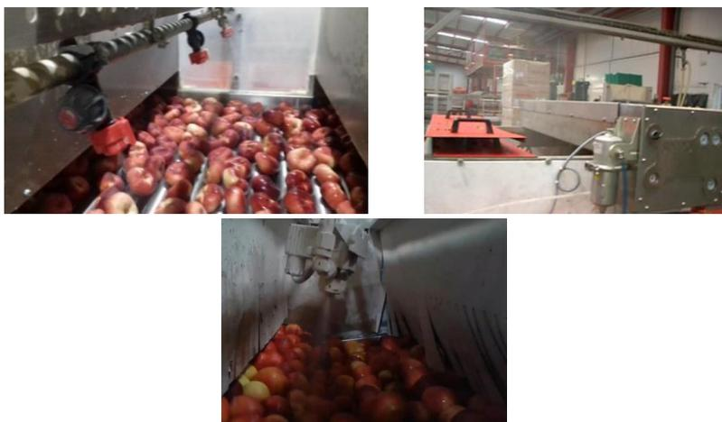
**Figura 8.** De izquierda a derecha: boquillas de caudal fijo y alto volumen, boquillas de caudal fijo y bajo volumen (Agrícola Rubies®) y boquillas de caudal variable (Tecnidex®)
