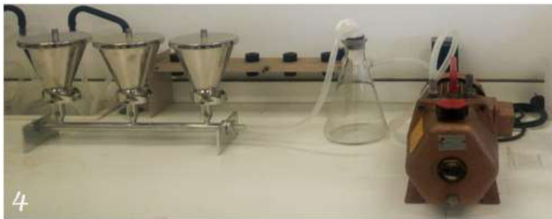
Figura 25. Instrumental utilizado para la extracción de esporas. 1. Agitador magnético; 2. Nido de tamices; 3. Centrifuga; 4. Rampa de filtrado con bomba de vacío.
