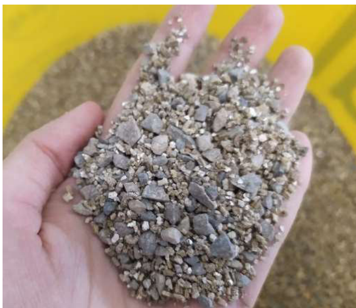
Figura 26. Mezcla de gravilla y vermiculita en relación 1:2,5.
