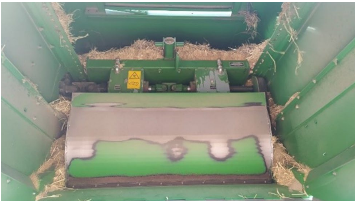
Figura 7. Identificar zonas desgastadas, sustituir las piezas y ajustar la máquina.
