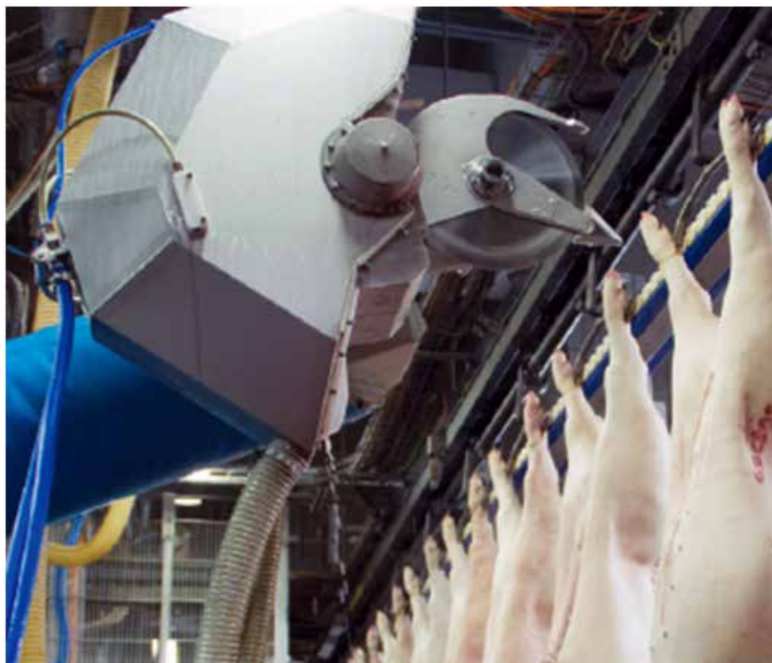
Figura 4. Robot abridor de panza y corte de tendón de hueso puente
