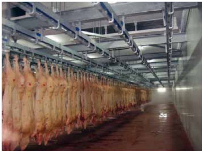
Figura 5. Cámara de estabilización de canales
