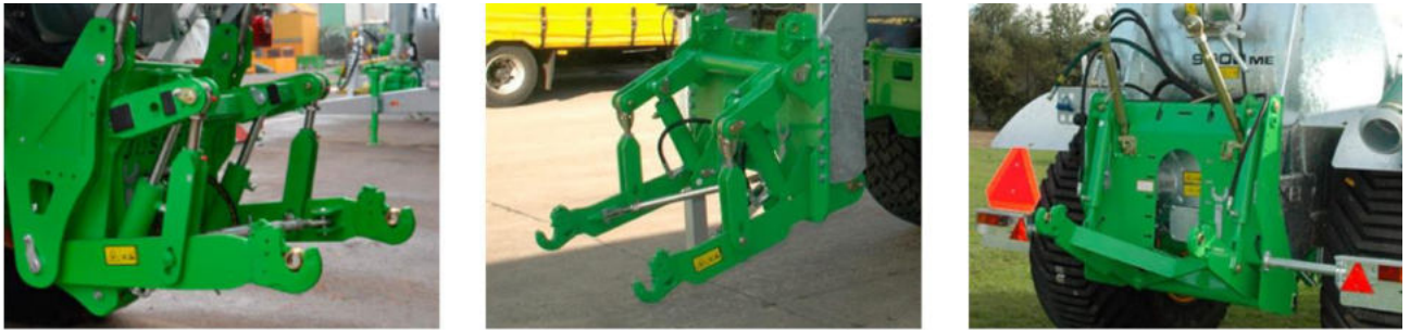
Ilustración 23. Sistema de enganche cuba-aplicador/injector.
