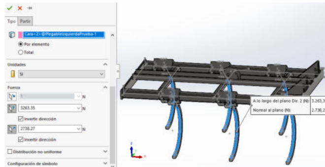
Ilustración 140. Direcciones principales de las cargas aplicadas sobre los brazos.
