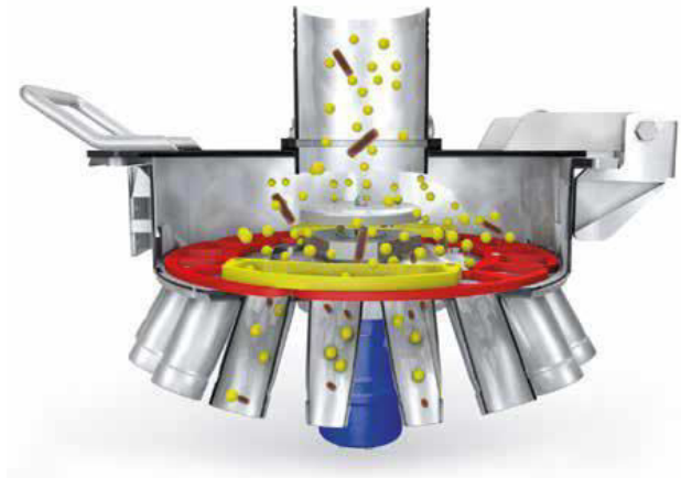
Ilustración 17. Corte de sección del distribuidor de purín.
