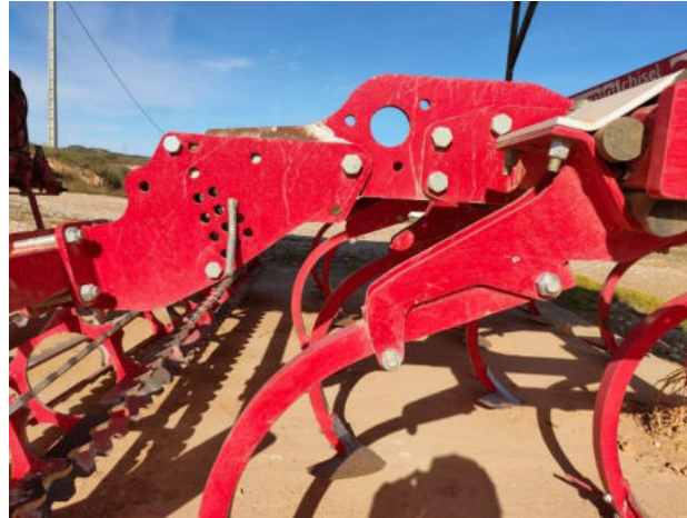
Ilustración 98. Desmontaje del brazo de la reja mediante dos tornillos.
