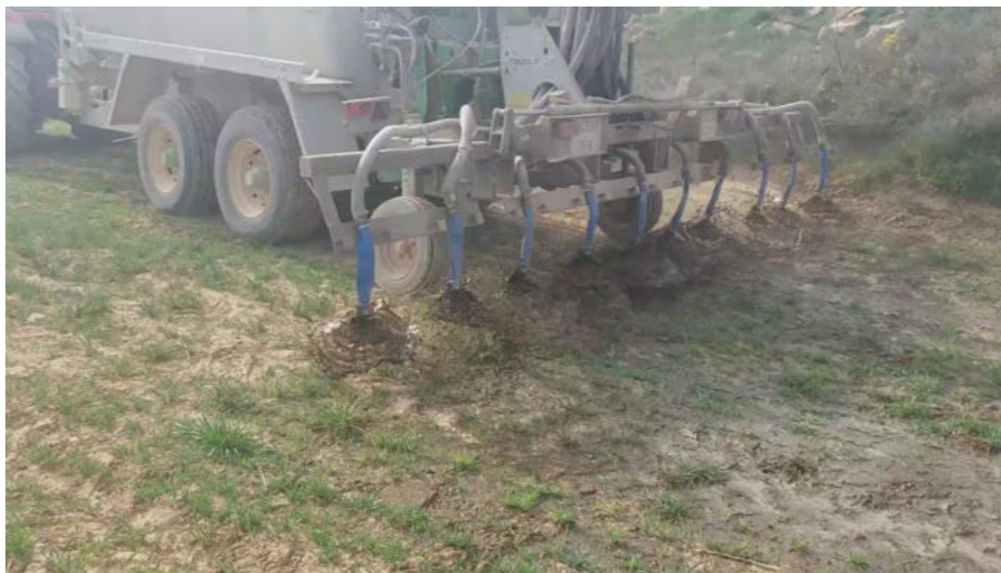
Ilustración 97. Funcionamiento de los platos para la aplicación en cobertera.
