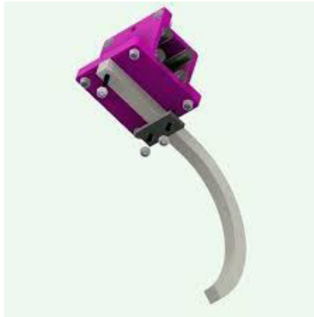
Ilustración 14. Brazo con elastómeros, es el sistema más ligero de todos.
