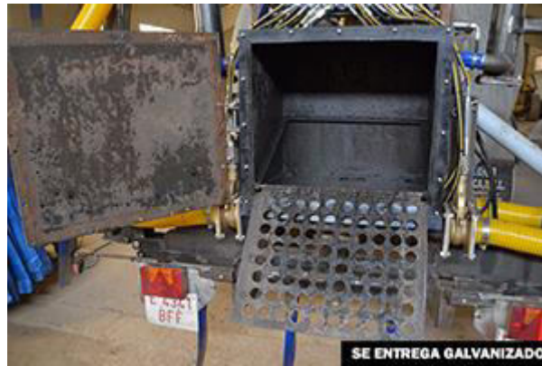
Ilustración 20. Sistema de filtraje en la entrada de purín al aplicador.
