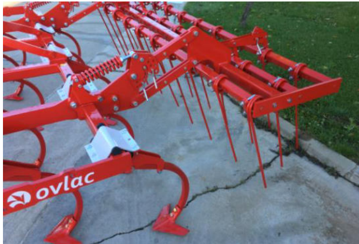
Ilustración 48. Ensamblaje de los brazos en la estructura.
