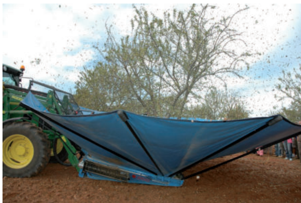
Figura 10.2. Vibrador de tronco con paraguas y descortezadora incorporadas.
