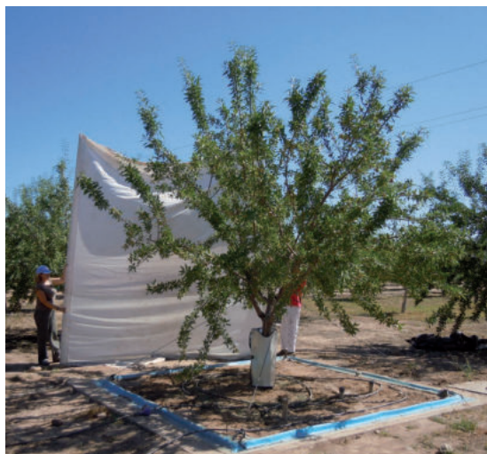
Figura 8.1. Imagen de un lisímetro de pesada en una plantación de almendro en una parcela experimental del IFAPA de Córdoba.
