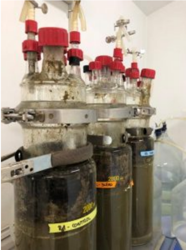
Figura 3. Reactores de mezcla completa utilizados en el estudio.
