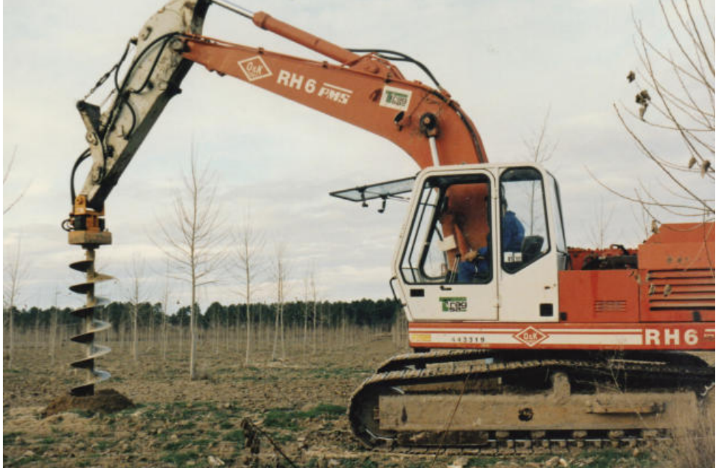
Barrena de grandes dimensiones para plantación a raíz profunda
