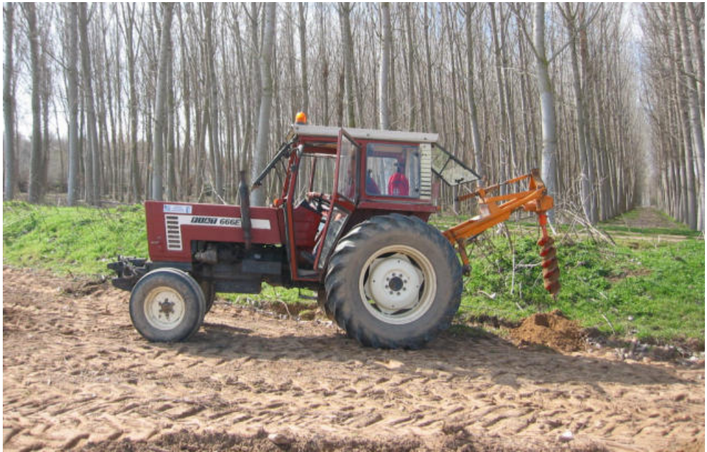
Plantación a raíz superficial con barrena
