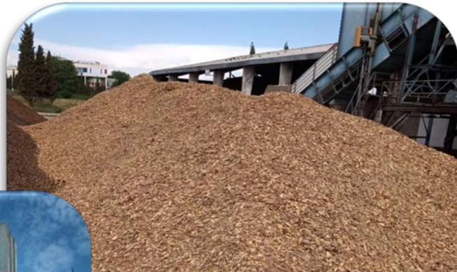
Para acelerar el proceso de secado natural, INDASA realizó el triturado del material. Posteriormente, se extendió de manera más homogénea en el suelo.
