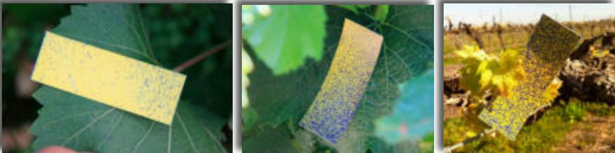
Imagen 16. Papel hidrosensible una vez efectuada la prueba, indicando las gotas impactadas (Santiago Planas)
