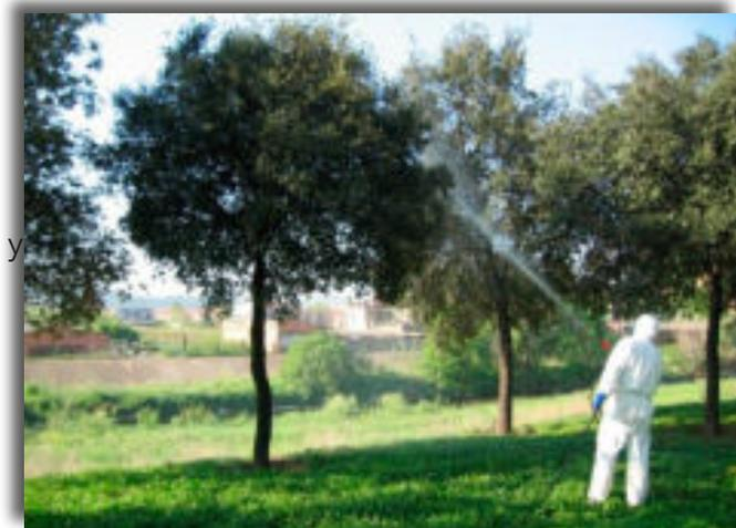
Permiten diferentes configuraciones de boquillas lo que posibilita su adaptación a la arquitectura del objetivo (barras horizontales para el tratamiento de césped o parterres, barras verticales para el tratamiento de barreras vegetales, pistolas lanzas para el tratamiento de arbustos). A pesar de que suelen estar equipados con bombas que permiten presiones muy elevadas, no se recomienda operar en ningún caso por encima de 15 bar.
