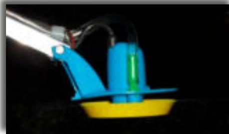
En función del diseño del cabezal y de las revoluciones de giro del motor, el caldo fitosanitario es proyectado a diferentes ángulos y distancias. Es habitual contar con patrones de distribución circulares y anchuras de trabajo de 1,2-1,6 metros.
