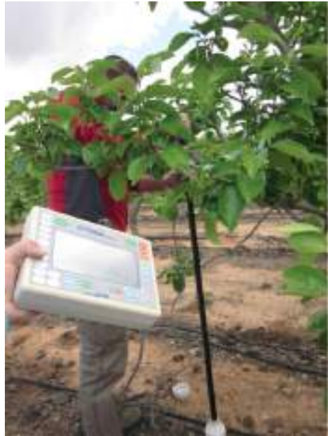
Figura 6.4. Medida de la humedad del suelo con sonda portátil para la gestión de riego en caqui.
