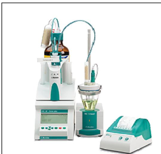
Figura 3.21. Valorador digital utilizado (Imagen de [www.metrohm.com](http://www.metrohm.com)).
