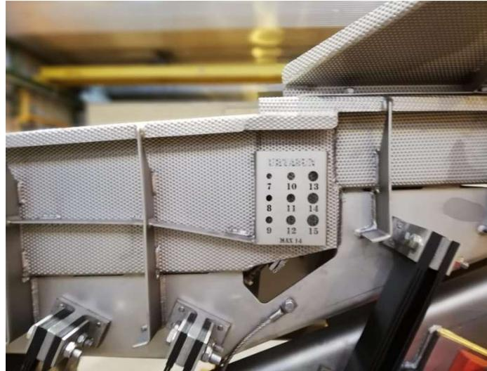
**Se han probado diferentes sistemas para poder observar cual es el mejor sistema de alimentación que separe las flores y permita alinear mediante un sistema de vibración, personalizado.**
