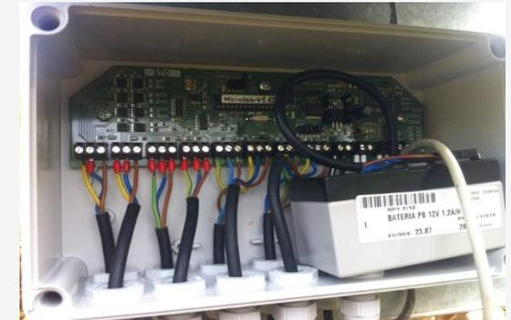
Sondas WATERMARK (A) y estación MicroISIS (B) utilizados para el seguimiento de la humedad del suelo en continuo.
