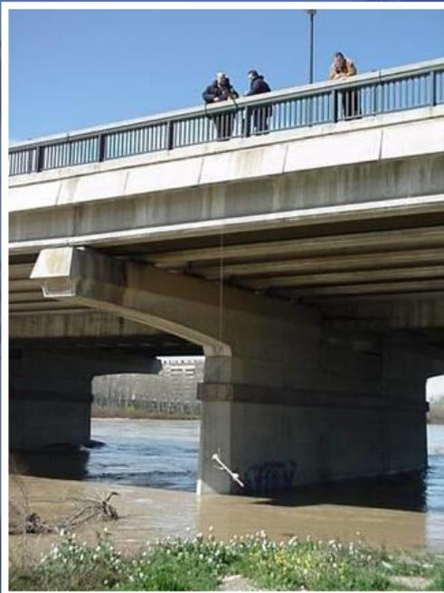
Las mediciones con molinete son laboriosas, complicadas y peligrosas con caudales altos. En ocasiones, es imposible realizar la medición
