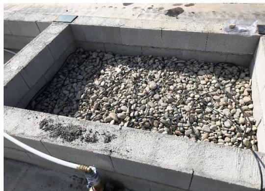
Fig. 7 Izquierda con estructura de protección y tuberías de riego, derecha lecho de grava e hilo radiante para calentamiento
