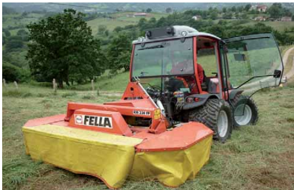
V.6.-Segadora de discos acoplada a la parte posterior de un tractor específico de montaña
