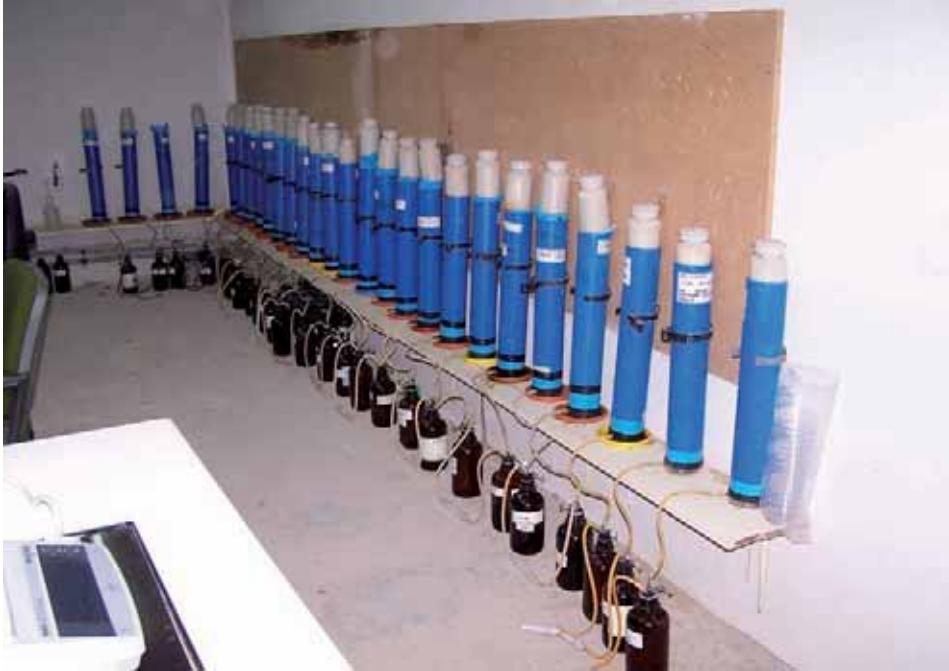
VII.3.-Aspecto de una batería de silos experimentales en las instalaciones del SERIDA
