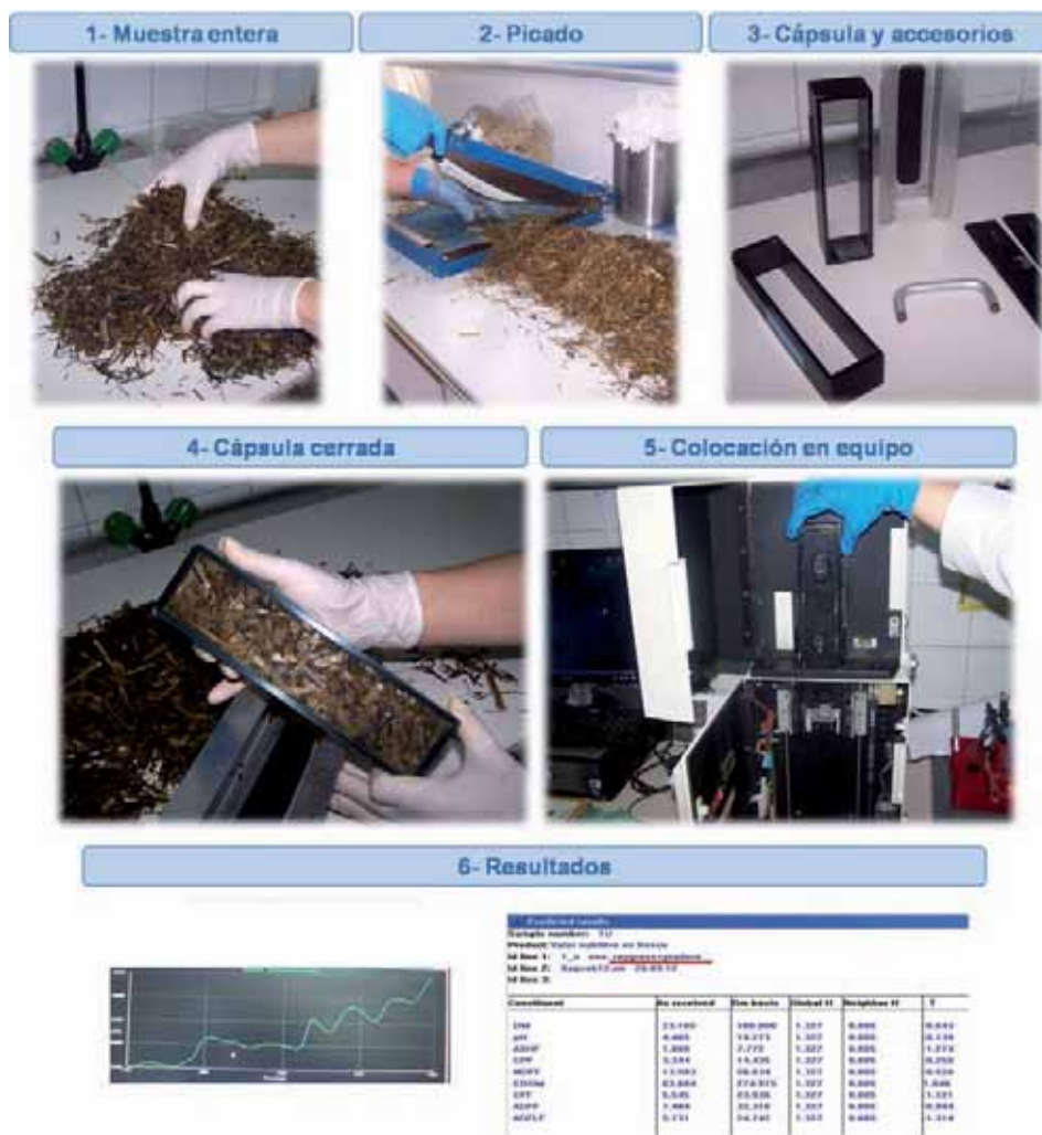
Figura XV. 13.- Análisis NIRS de una muestra de ensilado de hierba en estado natural
