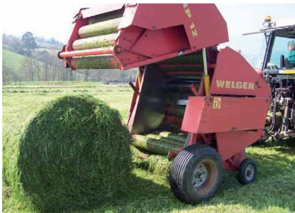
VI.2 (a, b).-Rotoempacadora de forraje en funcionamiento
