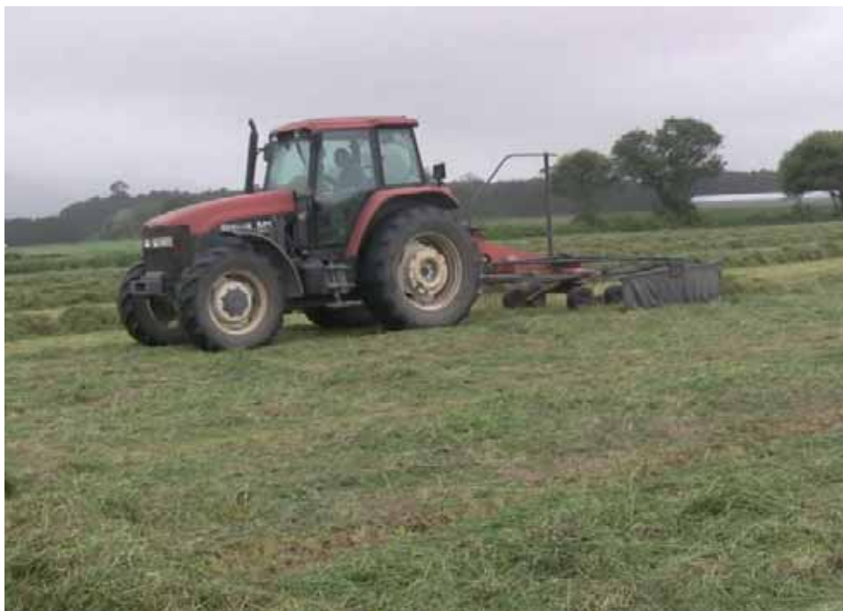
V.3(a, b).-Hilerado de forraje con rastrillo hilerador
