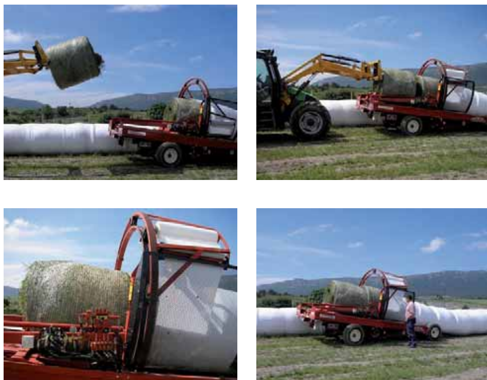
VI.6 (a, b, c, d).-Plataforma de encintado de rotopacas en funcionamiento
