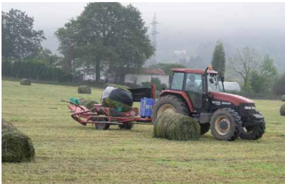
VI.5.-Encintadora de rotopacas en funcionamiento
