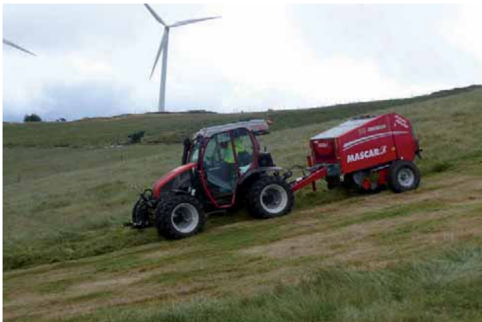
VI.9.-Rotoempacadora adaptada para trabajar en zonas de montaña
