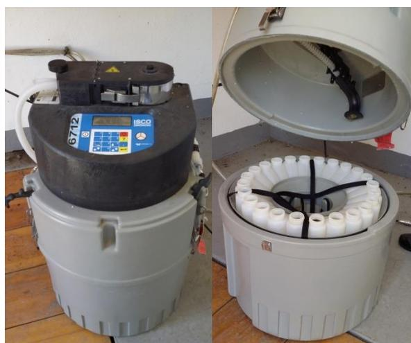
Fig. III.3. Tomamuestras automático ISCO 6712C instalado desde 2005 en la estación de aforos del B<sup>co</sup> de La Violada
