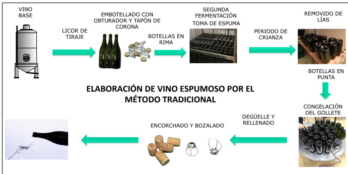
**Figura 3.17. Esquema de elaboración de vino espumoso por el método tradicional.**
