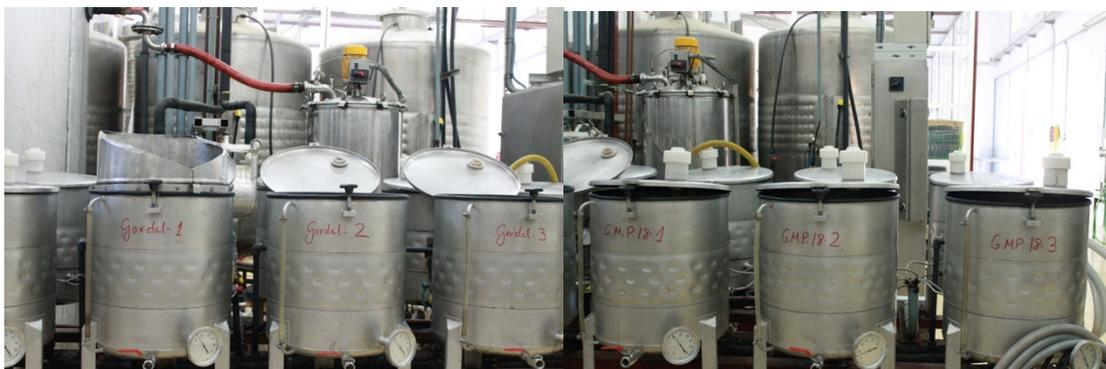
**Figura 3.16. Depósitos de fermentación en IFAPA de Cabra de vinos G y GMP18 del año 2015.**
