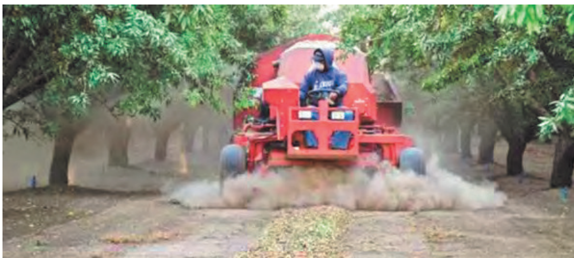
FIGURA 6. Recogida de almendra en suelo: elevada cantidad de polvo provocada por la máquina
