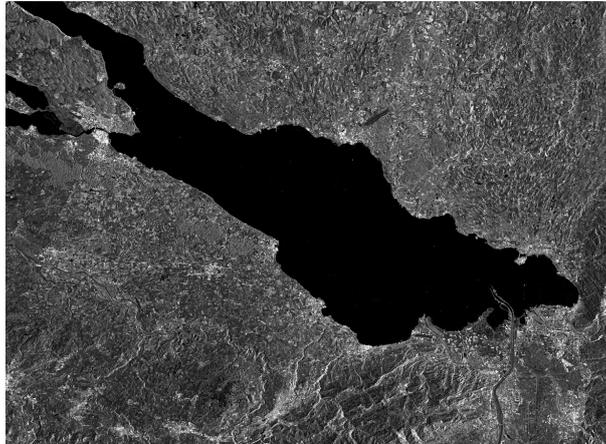
**Figura 2.3:** Mosaico de 46 capturas tomadas con el instrumento StripMap del satélite TerraSAR-X en el lago de Constanza, Alemania. **Fuente:** Airbus Defence & Space, n.d.
