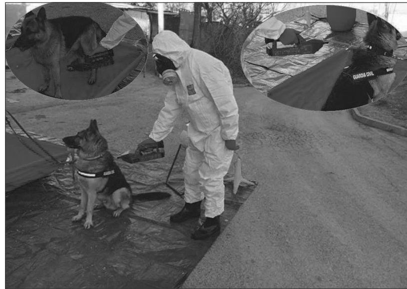
Figura 4. Control de la contaminación con un detector químico.
