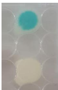
Figura 21. Imagen comparativa de dos papeles preparados con las mismas concentraciones de HRP ( 0,5 \text{ U mL}^{-1} ) y TMB ( 6 \cdot 10^{-4} \text{ M} ). Sobre el de arriba se añadió H_2O_2 en concentración 2,45 \cdot 10^{-6} \text{ M} , mientras que el de abajo, sigue intacto.
