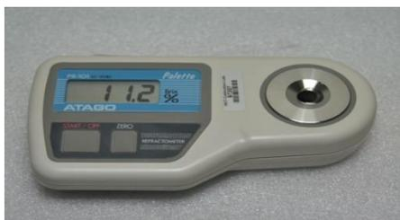
Imagen 5: Refractómetro digital PR-101ATAGO CO.
