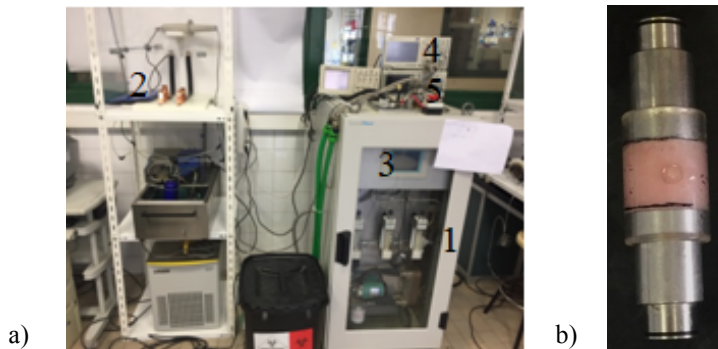
Figura 3. a) Equipo de PEAV ScandiNova. (1) Generador de pulsos, (2) Zona de tratamiento, (3) Pantalla táctil, (4) Osciloscopio, (5) Generador de funciones. b) Cámara de tratamiento de 2 x 2 cm.
