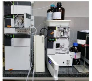
**Figura 14.** Detección y cuantificación de aflatoxinas por HPLC
