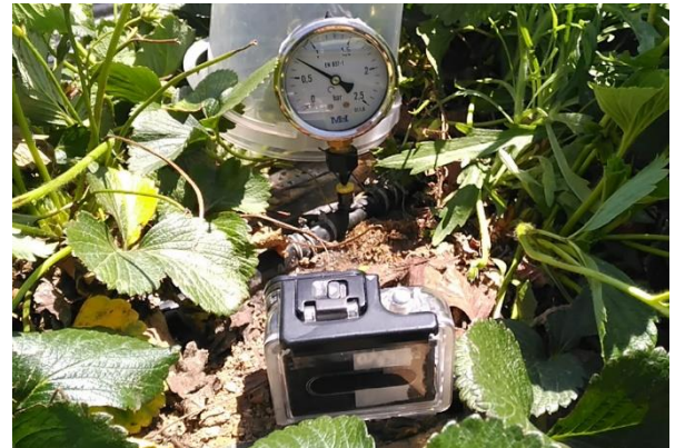
Figura 6. Grabación de la medida de presión en continuo con cámara deportiva
