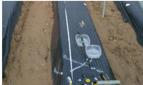
Figura 11. Dos recipientes de medida de volumen. Uno para el pulso de riego y otro para la fase de vaciado
