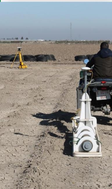
Figura 2. Medición de la CEa del suelo con un sensor de inducción electromagnética (DUALEM-21S), integrado en una plataforma móvil dotada de sistema de posicionamiento GPS-RTK.
