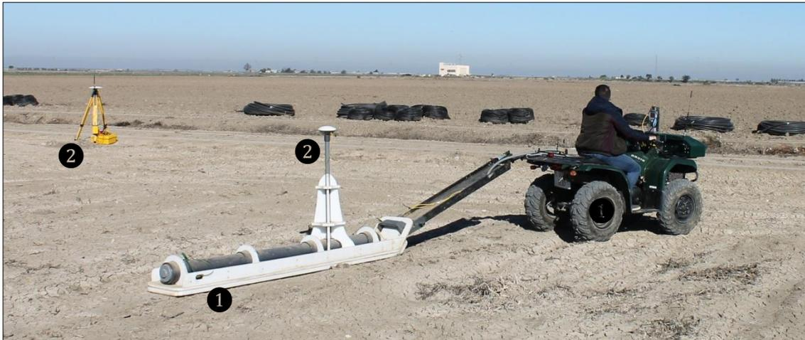
Figura 8. Plataforma móvil de medición de la CEa. El sensor DUALEM-21S se sitúa en el interior del tubo gris del trineo (1). Al fondo a la izquierda se observa la estación base del sistema GPS-RTK (2)
