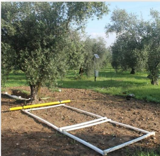
Figura 30. Plataforma usada para realizar periódicamente las mediciones de la CEa con el sensor DUALEM-21S.
