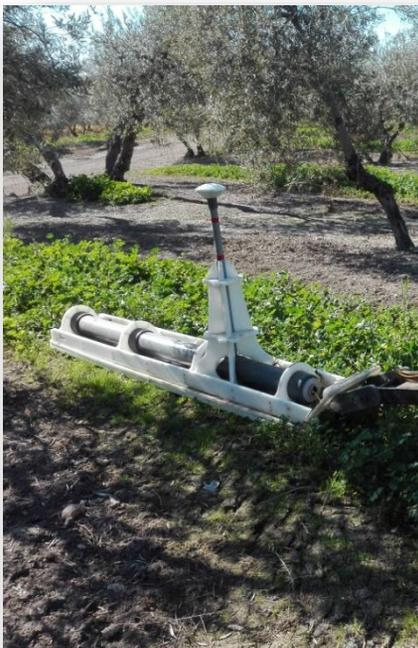
Figura 5. Detalle del trineo en el que se desplaza el sensor de inducción electromagnética (DUALEM-21S) sobre la superficie del suelo.
