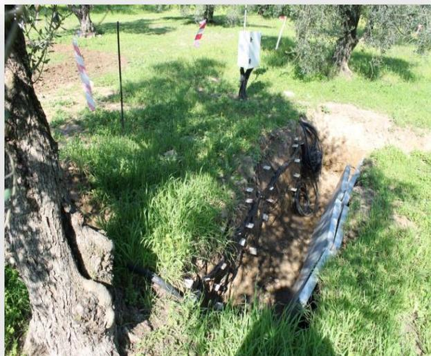
Figura 31. Conjunto de sensores de humedad instalados en una zanja bajo el olivo estudiado.
