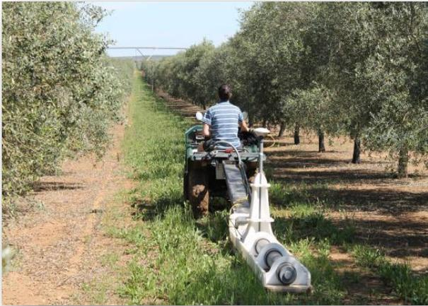
Figura 28. Medición de la CEa en un olivar con el sensor de inducción electromagnética (DUALEM-215).
