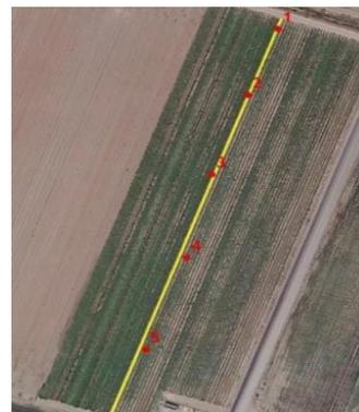
Figura 23. Posición del transecto con mediciones de CEa y los puntos de muestreo de suelo en la parcela experimental
