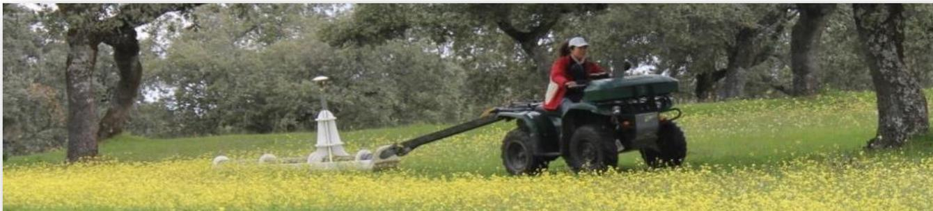
Figura 11. Medición de la CEa con el sensor de inducción electromagnética DUALEM-21S en una dehesa
