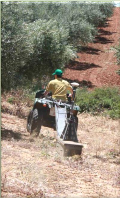
Figura 1. Medición con un sensor de inducción electromagnética (EM38-DD) en un olivar.
