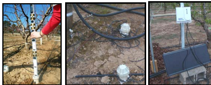
Sonda Enviroscan Tubos de acceso Data Logger
