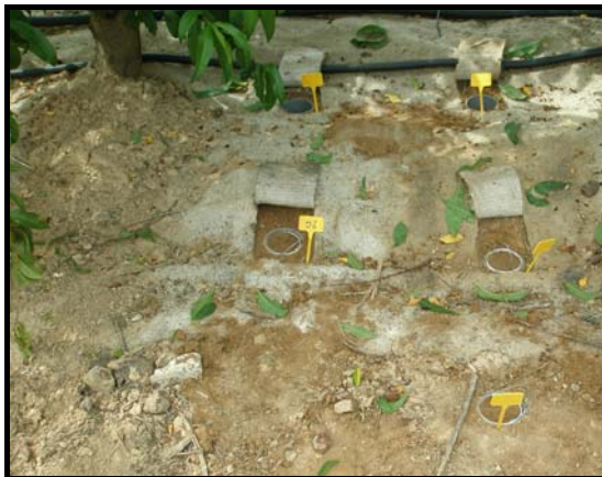
Figura IV.9. ML instalados en el suelo acolchado con geotextil de yute.
