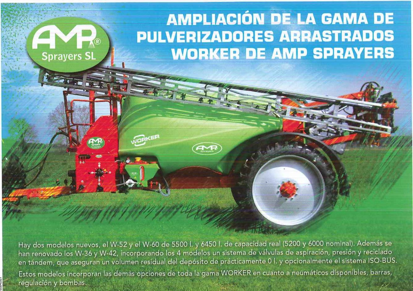
Hay dos modelos nuevos, el W-52 y el W-60 de 5500 l. y 6450 l. de capacidad real (5200 y 6000 nominal). Además se han renovado los W-36 y W-42, incorporando los 4 modelos un sistema de válvulas de aspiración, presión y reciclado en tándem, que aseguran un volumen residual del depósito de prácticamente 0 l. y opcionalmente el sistema ISO-BUS. Estos modelos incorporan las demás opciones de toda la gama WORKER en cuanto a neumáticos disponibles, barras, regulación y bombas.
