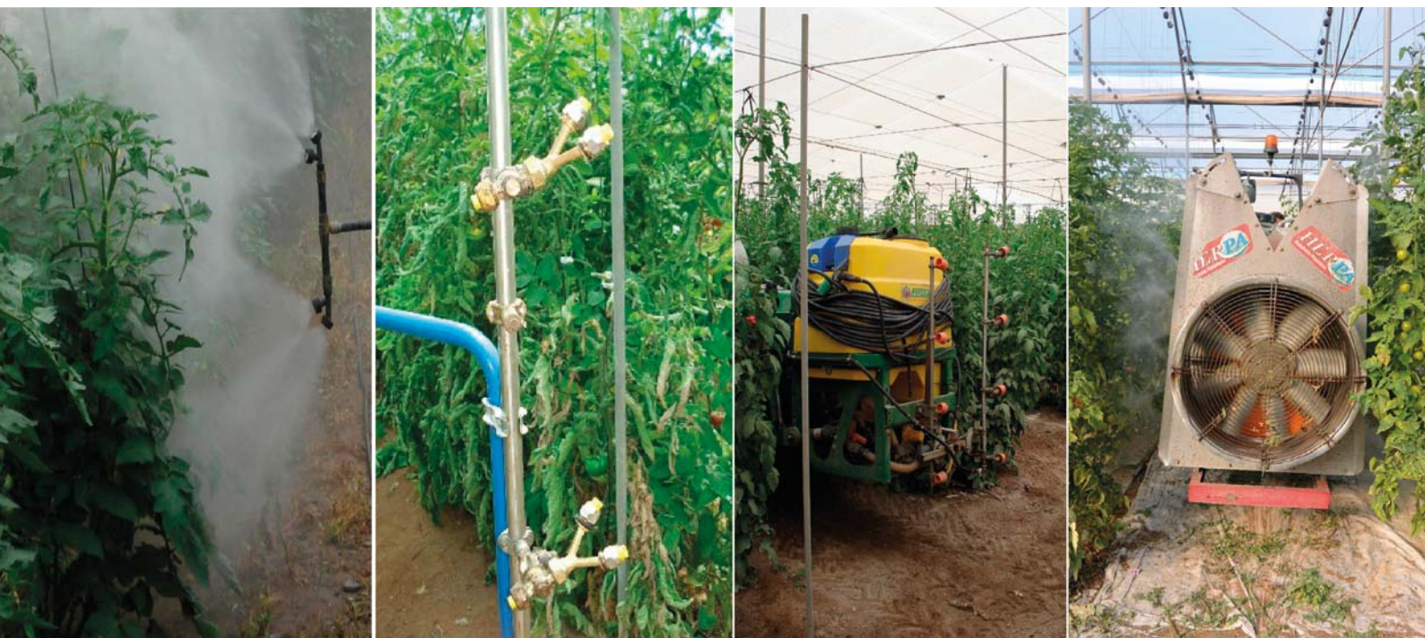
Los tipos y distribución de boquillas, presiones de trabajo y presencia o no de ventiladores, y sus características, determinarán la eficiencia de las aplicaciones.
